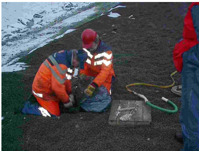
Figur 8: Prøvetaking av utlagt, komprimerte materiale.
